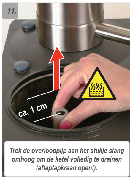
Leeg de heetwaterketel via de aftapkraan.
