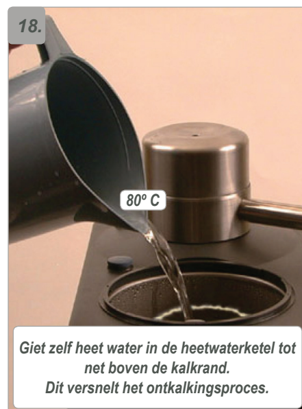
De heetwaterketel wordt met water gevuld en verwarmd. Dit duurt enige tijd.
